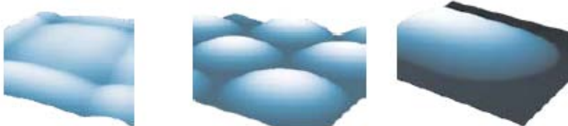
左: 矩形レンズ (ピッチ: 500 \mu\text{m} 、高さ: 5.5 \mu\text{m} )
