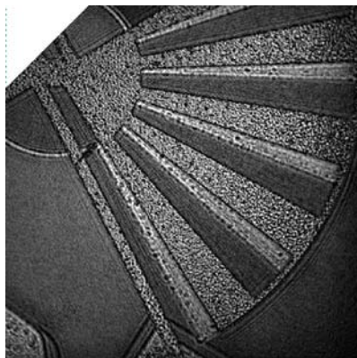
LEG-EPFL 提供のパッケージされた回転する可変キャパシター。
